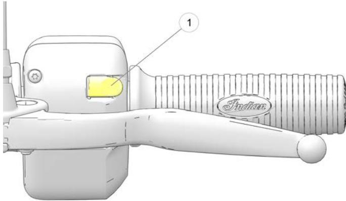
L'interruttore di accensione deve essere in posizione ACCESO perché i commutatori possano funzionare. Usare il comando sul lato destro per navigare attraverso i menù o accettare le finestre di dialogo sul display Ride Command. Usare l'interruttore sul lato sinistro per uscire dai menù, rifiutare le finestre di dialogo, riagganciare il telefono e spostarsi tra le schermate del display.
