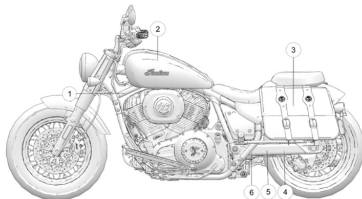
① Numero d'identificazione veicolo (VIN) (sul lato della testa dello sterzo)
