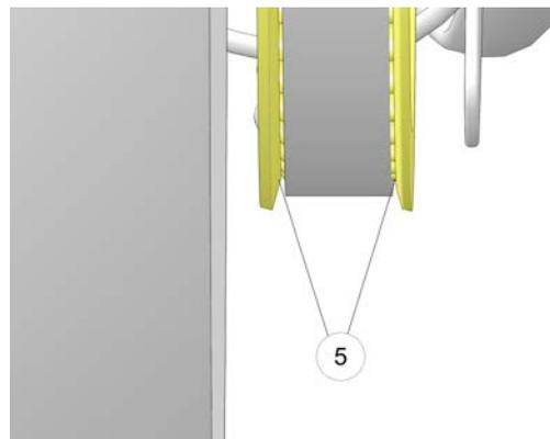
3. Se necessario, allentare il bullone dell'asse e il registro SINISTRO finché la cinghia non si stacca dalla flangia destra e inizia ad allinearsi al centro della flangia portacorona condotta durante la rotazione in avanti della ruota.
