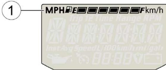
I segmenti dell'indicatore del livello del carburante ① mostrano il livello del carburante nel serbatoio. Quando scompare l'ultimo segmento, si attiva la spia di riserva carburante. Tutti i segmenti e l'icona del carburante lampeggiano. Fare immediatamente rifornimento.
