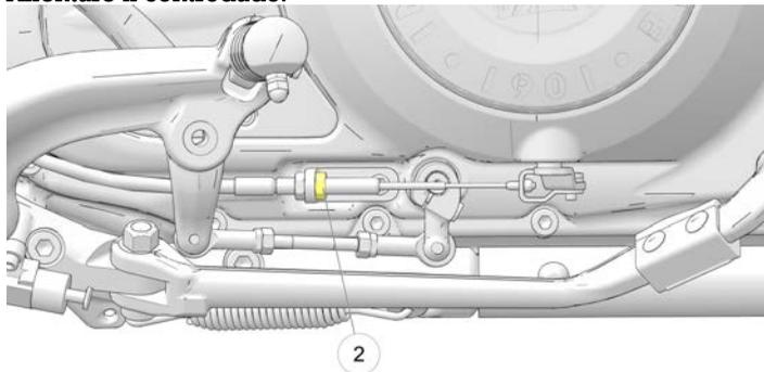
3. Girare il dado di regolazione del cavo verso l'interno o verso l'esterno finché il gioco della leva della frizione non risulta di 0,5-1,5 mm, misurato nella sede della leva.
