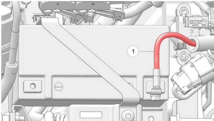
6. Inserire la cinghia di tenuta della batteria nell'apposita fessura sulla scatola portabatteria e farla scorrere verso la parte posteriore della motocicletta.
