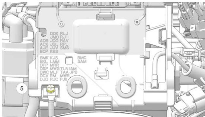
10. Installare il cavo dell'antenna sul vassoio superiore della batteria. Accertarsi che il cavo sia fissato in entrambi i punti di tenuta.
