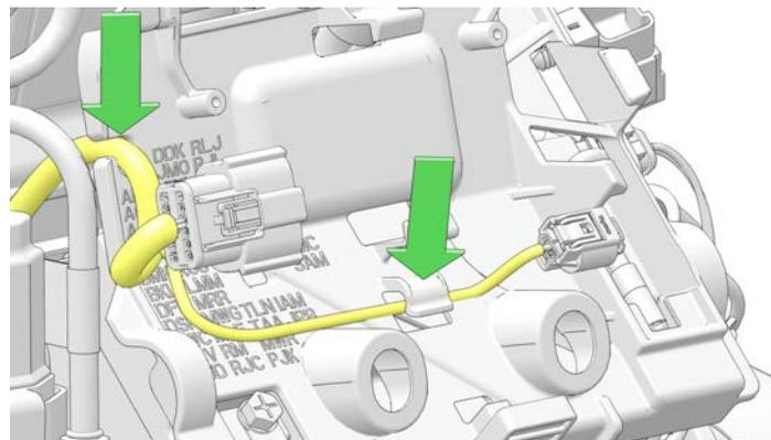
11. Installare l'antenna ⑥ sul vassoio superiore della batteria.
