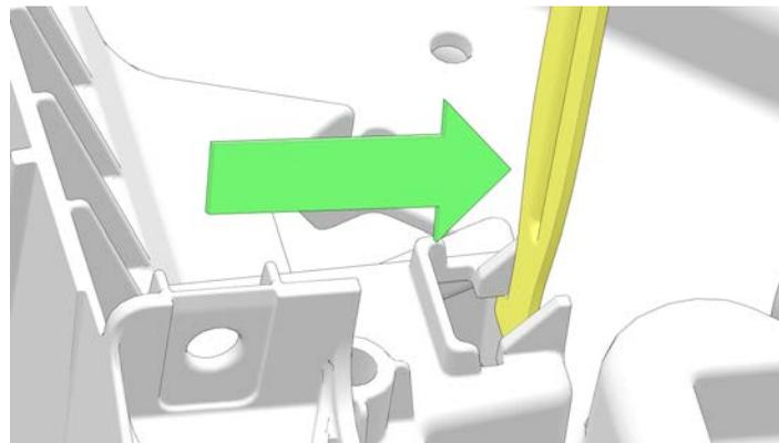
7. Inserire nella cinghia di tenuta della batteria ② il relativo dispositivo di fissaggio ③.
