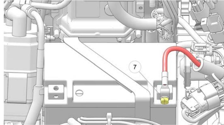
7. Sollevare la parte posteriore del vassoio superiore della batteria e tirarlo verso la parte posteriore dell'unità per asportarlo.
