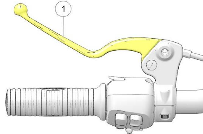
2. Il gioco (distanza) è l'escursione della leva dalla posizione di riposo al punto in cui il cavo fa resistenza. Il gioco della leva della frizione deve essere di 0,5-1,5 mm. Misurare la distanza tra la leva della frizione e il punto di contatto della leva ②. Regolare il gioco della leva della frizione, se necessario.
