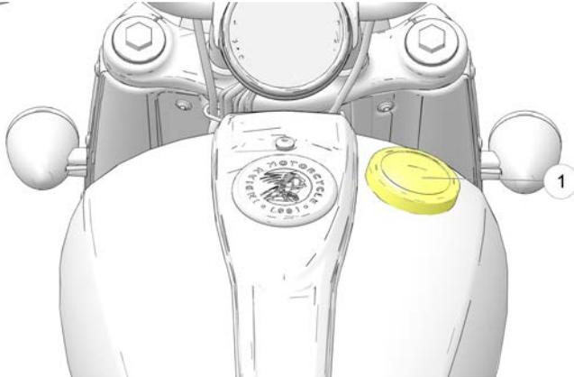
Girare il tappo del serbatoio del carburante in senso antiorario per rimuoverlo. Se il tappo del serbatoio è dotato di un cavetto, collocare il tappo delicatamente sul serbatoio, appoggiato sulla gomma antiurto. Vedere pagina 80 per istruzioni sul rifornimento di carburante. Per serrare il tappo, girarlo in senso orario finché la guarnizione non aderisce bene al serbatoio; quindi continuare finché il tappo non scatta diverse volte.
