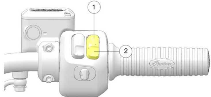
Premere la parte superiore dell'interruttore (ARRESTO) ① per interrompere i circuiti e arrestare il motore. Il motore non deve essere avviato o in funzionamento se l'interruttore è nella posizione di ARRESTO.
