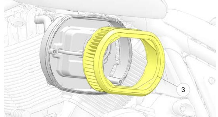
3. Pulire la superficie di tenuta del filtro sulla piastra d'appoggio.
