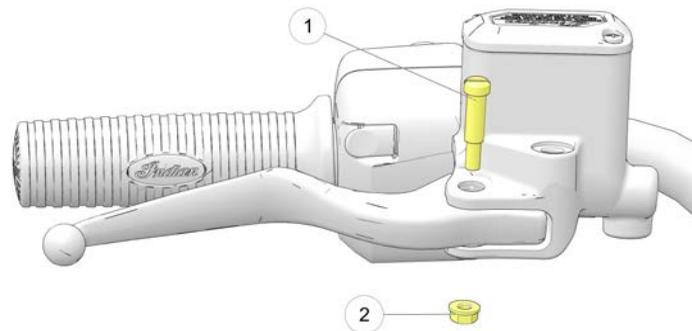
2. Installare il perno di snodo ①. Serrare il perno di snodo secondo le specifiche.
