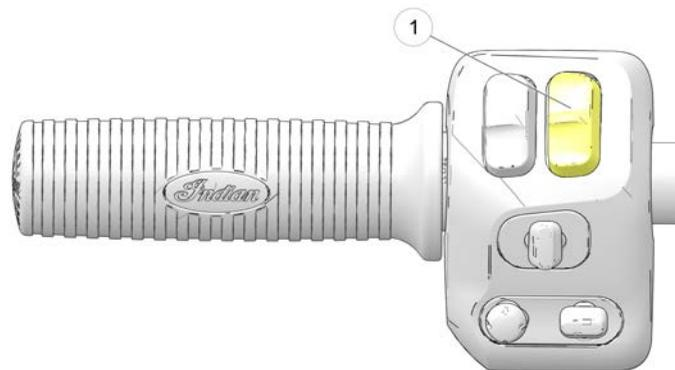
Il faro anteriore si accende automaticamente quando viene avviato il motore. Per maggiori informazioni sul comando automatico del faro anteriore vedere pagina 41.
