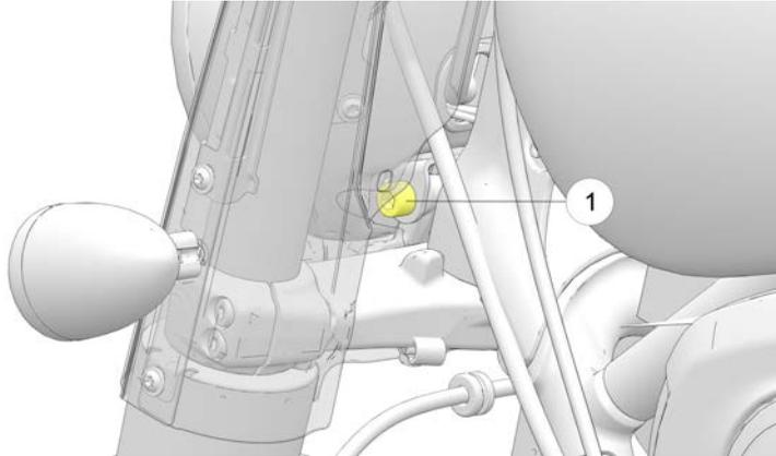
1. Per regolare verticalmente il faro anteriore allentare il dispositivo di fissaggio dello snodo del faro. Girare il faro verso l'alto o verso il basso.
