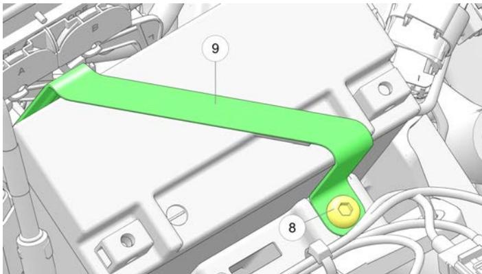
10. Rimuovere la cinghia della batteria spostandone la parte anteriore fuori dal dispositivo di tenuta sulla scatola della batteria.
