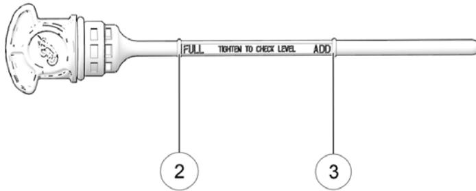
7. Reinstallare saldamente l'astina.
